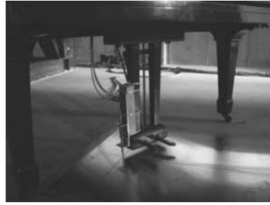
図 15. ペダルに取付けた変位計
