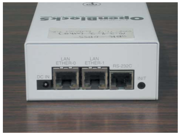
図 3. OBS266 本体の各種ケーブル差し込み口の写真。左より、電源、LAN1、LAN2、RS-232C、一番右は、シャットダウンを行うためのボタン
