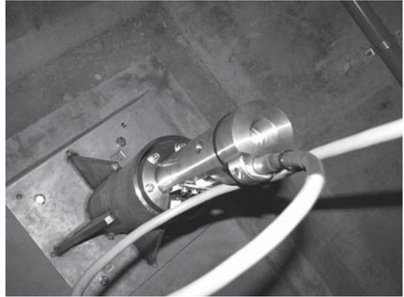
図 34. 地震計の円筒ステンレス金具に挿入取付け状況 (風の塔)
