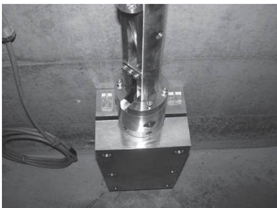
図 29. 地震計取付け状況の拡大. レベル調整器の取付け状況（海ほたる）
