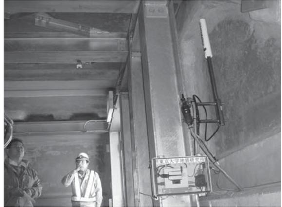
図 37. GPS アンテナと送信装置を設置した状況（風の塔）
