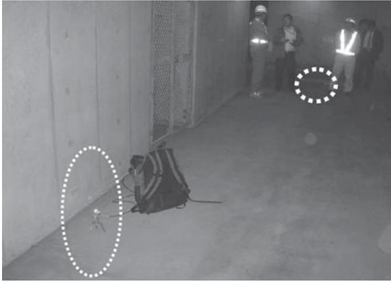
図 11. 後方○印の壁面を利用して垂直に地震計を固定手前ノイズ調査の地震計（海ほたる）
