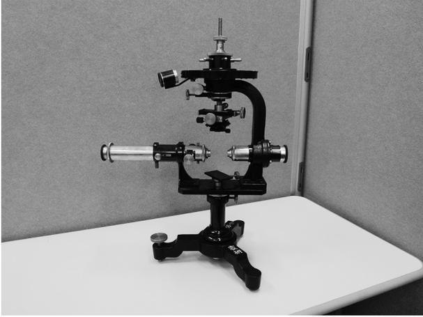
写真 2-1. 結晶方位測定装置
