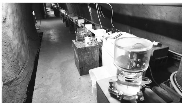
図8. 坑内計測室を坑口方向から撮影。中央の台には手前が読み取り式水管傾斜計、奥のガラス容器が磁気センサーを使用した水管傾斜計、右手前の台上には渦電流センサーを使った震研90型水管傾斜計の観測用ポッドが載っており並行観測している。伸縮計は外気の影響を避けるため発泡スチロールで覆われている。
