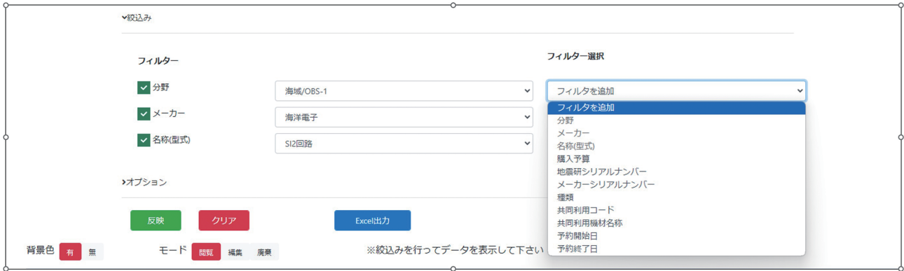
図 5. 全体検索画面の絞り込み機能. フィルター機能にて分野やメーカー, 名称(型式)等で絞り込める. 絞り込みをより簡単にするために, 既に登録されている情報をリストする.
