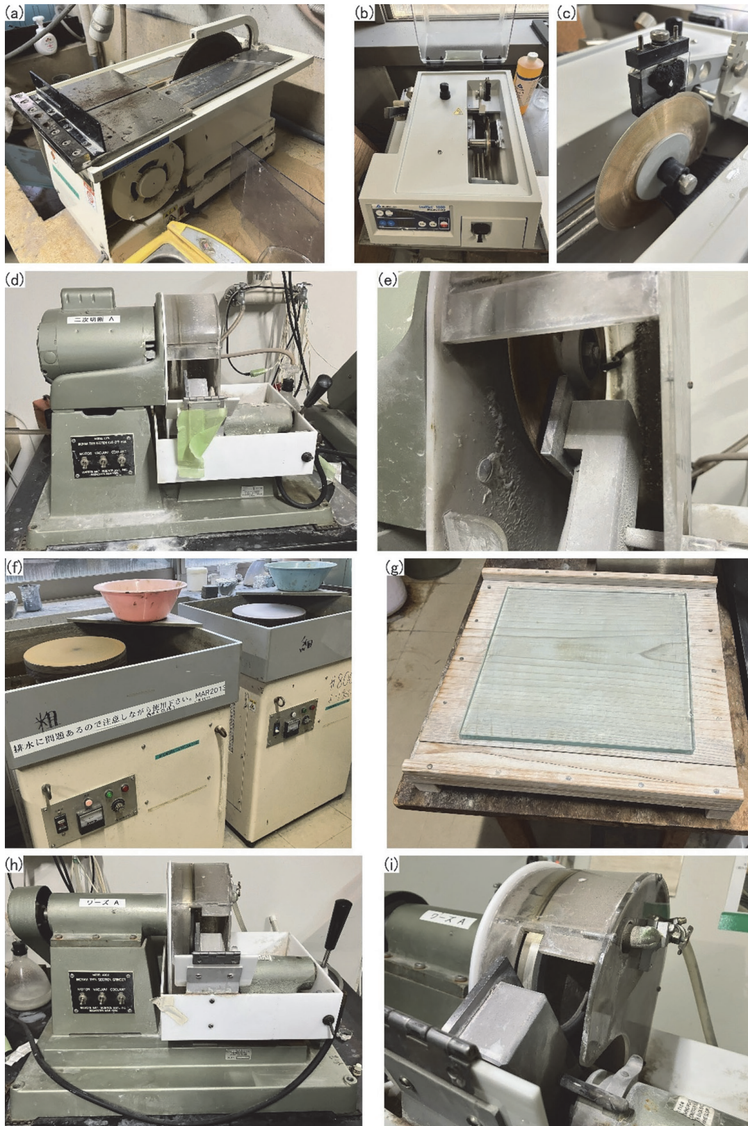
図 2. 東京大学地震研究所の薄片室で使用されている機材。(a) 小型カッター, 試料の整形に使用する。(b) 精密カッター, 小型カッターよりも回転刃が薄く, 低速度に設定した切断が可能である。多孔質試料の整形・二次切断に使用する。(c) 精密カッターの回転刃と試料ホルダー。(d) 二次カッター, 二次切断に使用し, 試料を薄くする。(e) 二次カッターの回転刃。(f) グライNDER, 回転する円盤上に研磨剤を散布し, 研磨を行う。(g) 研磨用ガラス板, #1500 以上の研磨剤による研磨時に使用する。(h) ドラム式研磨機, 二次切断後の研磨に用いる。試料を 100\ \mu\text{m} 程度まで薄くすることができる。(i) ドラム式研磨機の回転ドラム。
