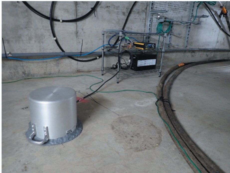
図 6. 地下ピットの広帯域地震観測点設置風景 寸胴の鍋を簡易耐圧容器としてセンサーを保護している
