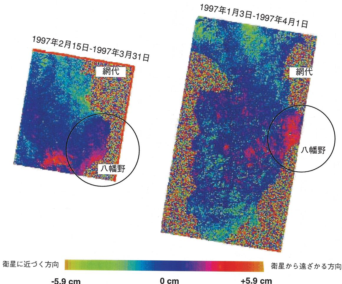
図3 (本文p. 3) 差分干渉SAR (合成開口レーダ) 解析でみる、伊豆半島の地殻変動。1997年3月上旬の群発地震による変動が、西側上空570 km上空にある衛星 (JERS-1 ふよう1号) から、伏角55度で地表面を見おろしたときの、地表までの視線距離変化として現れている。網代付近では南東変位 (視線距離減少)、八幡野付近での南西変位 (視線距離増加) はGPS観測と一致する。データ提供は宇宙開発事業団・通産省・小林・大久保・藤井の発表。
