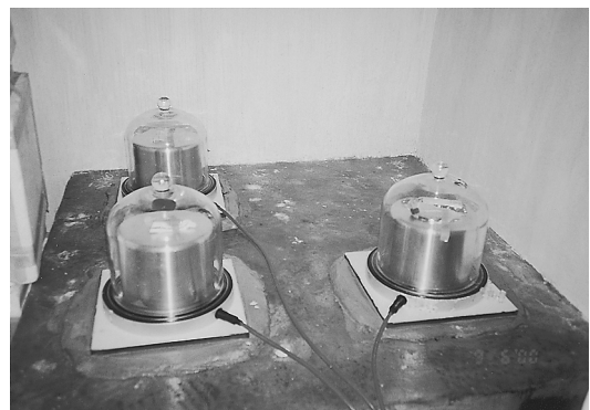
写真3 STS-1地震計の設置風景。
