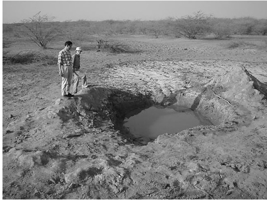
図 8 地下水の噴出跡1. 地震による液状化により、砂漠の真中に池が出現した。後方の白い部分は塩であり、実際筆者らが池の水をなめたところ塩辛い味がした。
