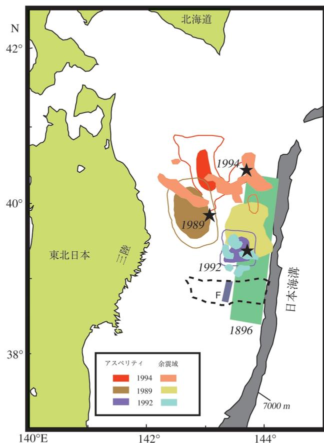
図2 (本文p. 3) 最近三陸沖で起きた三つの大地震 (1989, 1992, 1994年) のアスペリティ (永井他, 2001; 山中・菊地, 2001) と余震分布 (永井他, 2001; Hino et al., 1996; 東北大学, 1990), および1896年津波地震の断層面 (Tanioka and Satake, 1996). 1896年断層領域は最近の地震ではほとんど破壊していない. 点線で囲った領域は, 微小地震活動がきわめて低いところであり, 測線F下のプレート境界に沿って強い反射面が見ついている (藤江他, 2000).
