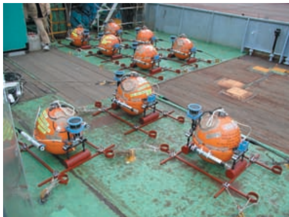
長期観測型の自己浮上式海底地震計。 Long-term pop-up type ocean bottom seismometers on ship.
