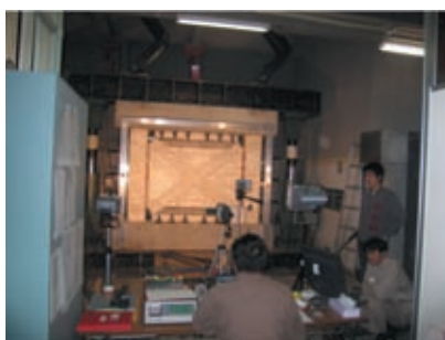
鉄筋コンクリート壁の耐震性能試験 (地震研究所地下2階, 2004.11) Seismic performance test of reinforced concrete wall at ERI, November 2004
