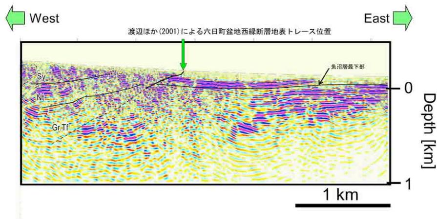
図 六日町断層先端部を横切る反射法地震探査断面と地質学的解釈
