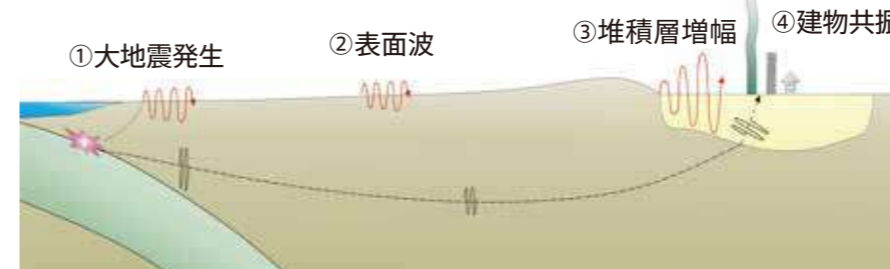
大地震によって、大型平野で長周期地震動が生成するメカニズム
