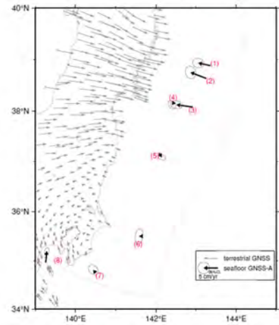
図 8．日本海溝沿いの直近約 4 年間の水平移動速度。北米プレート固定（海上保安庁〔課題番号：JCG_03〕）。
