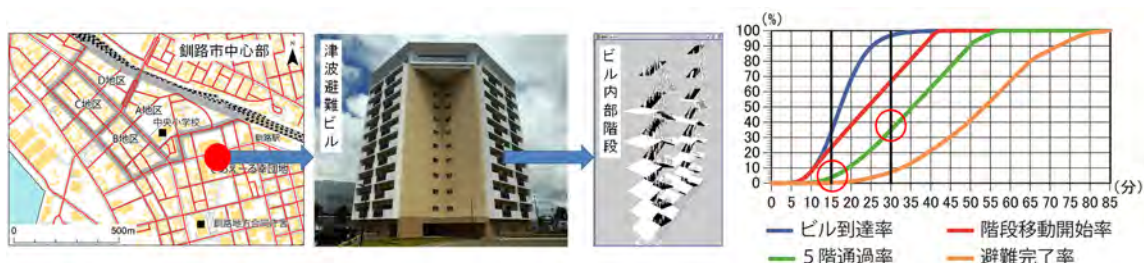
図 6. 道路ネットワークとモデル化した階段を連結した津波避難ビルへの避難行動シミュレーション（事例では 1,000 人収容の避難ビルに、津波到達までの 30 分間で 30% 程度しか避難できなかった）（北海道大学〔課題番号：HKD_07〕）
