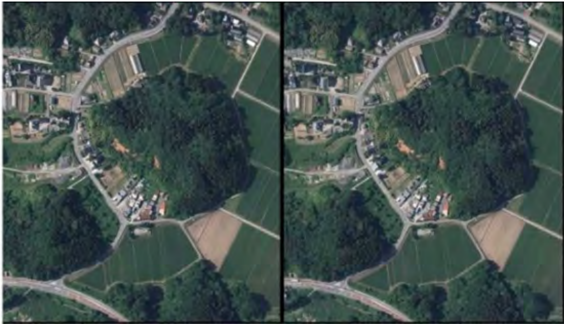
図4 2019年山形沖地震後斜面の滑落が見られる
