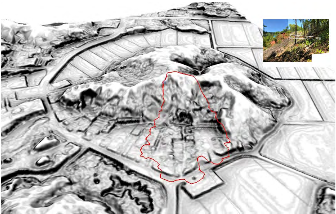
図6 土砂災害予測基本図鳥観図（2019年6月測量実施）赤実線は地すべり部
