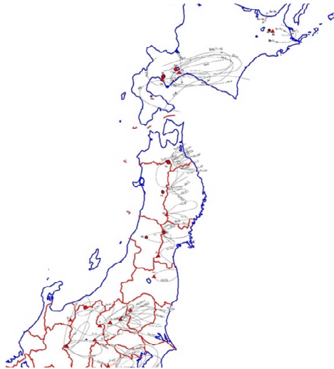
図 11. 新編火山灰アトラスから抽出した関東以北における 9000 年から 12 万年前の時代で厚さ 10 cm 以上の軽石層の分布範囲 (灰色線)。風化が進んだ 9000 年以上前の軽石層がすべり面形成に大きな役割を果たしており、これらの地域が地震によるテフラの崩壊の発生が危惧される場所と考えられる (京都大学防災研究所 [課題番号: DPRI10])。
