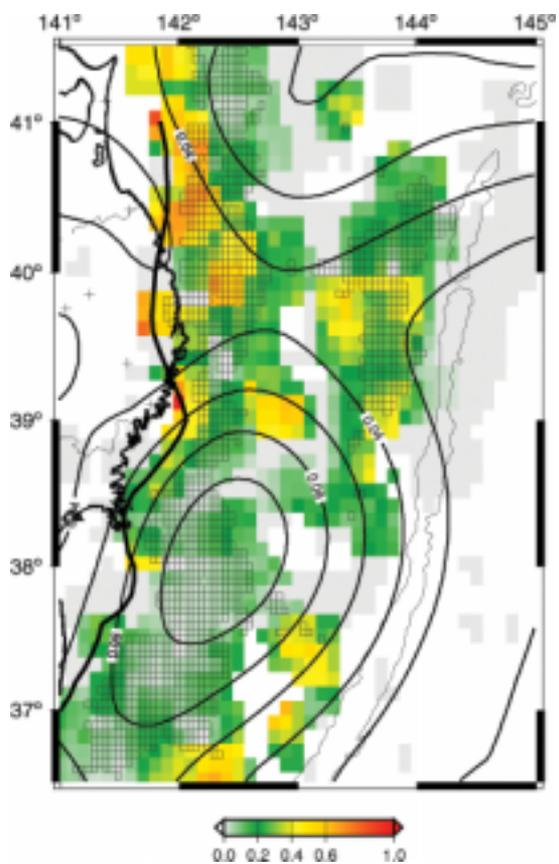
図1．相似地震の相対発生頻度分布．1997年1月から2001年7月に発生したM2.5以上で70 km以浅の地震に対する相似地震の割合をカラーパターンで示す．コンターは、同時期におけるGPSデータから得られたバックスリップの分布（諏訪，2002）．
