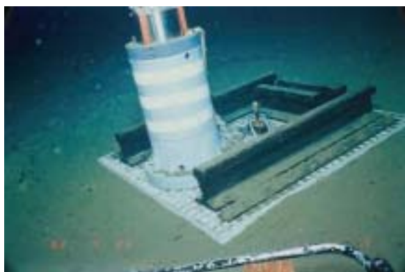
図2 海洋科学技術センターの無人探査機「かいこう」の調査航海により観察された高精度トランスポンダーの着底状況.
