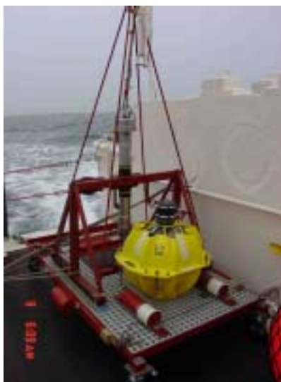
図1 平成14年度に開発した海底部リピータ型トランスポンダの設置システム. 平成13年度の開発では10,000mまでの超深海底用としてチタン製円筒型耐圧容器を使用した 1) が, 平成14年度は計測部をガラス球に収容して水深6,000m程度の深海底での計測用とした. 計測部は13年度のをさらに改良した.
