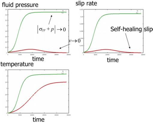
図1. 断層の動的破壊時の流体圧、すべり速度、温度の時間変化のシミュレーション結果. 圧力、速度、温度、時間は無次元量. 赤い線は  $\alpha_f / \alpha_s = 21$  の場合、緑色の線は  $\alpha_f / \alpha_s = 4.2$  の場合を示す.  $\alpha_f$ ,  $\alpha_s$  は液相、固相の熱膨張率を表す.
