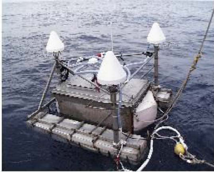
図2.GPS音響測位システムの計測ブイの外観. ブイの位置・姿勢を決定するために3台のGPSと動揺計を装備する. 箱状容器の中には, 計測のためのAD変換器, コンピュータ等を収容し, 観測船と無線LANでリンクする. 送受信器はブイの下に吊り下げ固定され
