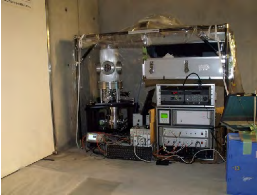
図1 微小距離投げ上げ装置を用いた絶対重力観測（桜島・有村観測坑道局舎・国土交通省九州地方整備局大隅河川国道事務所）
