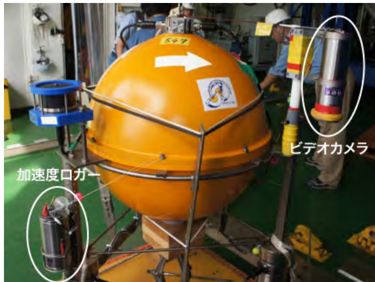
図3 BBOBST-NXに取り付けたビデオカメラと加速度ロガー BBOBST-NXの着底時に傾斜する原因・時点を観察するため、小型・自記型のビデオカメラと加速度ロガーを独自に開発した。9月のBBOBST-NX設置前の写真を示す。ビデオカメラには小型のアクションカメラ、LEDとリチウム1次電池を内蔵し、5時間程度の連続撮影が可能である。
