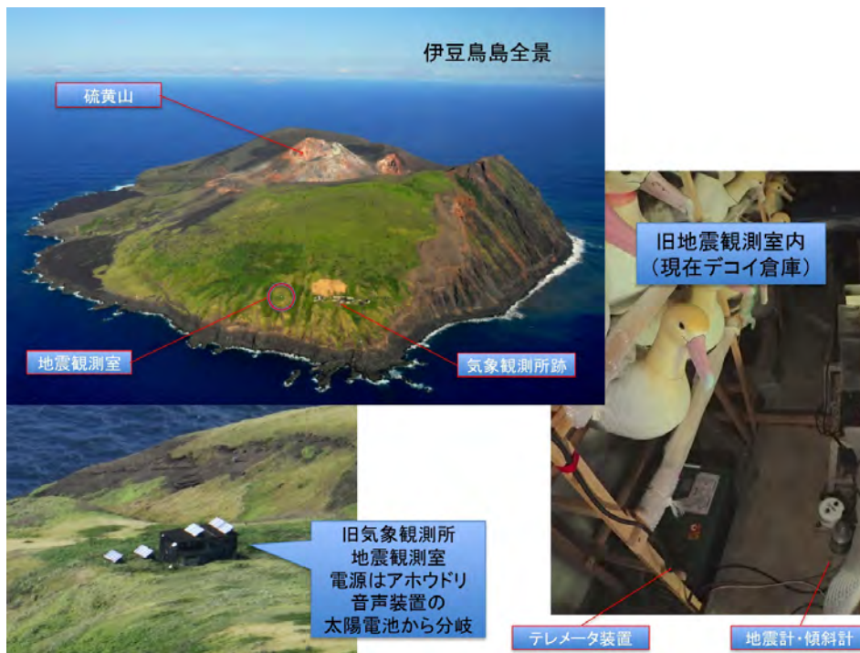
図1 伊豆鳥島に設置した、新開発の衛星携帯電話利用のデマンド型テレメータ地震観測装置
