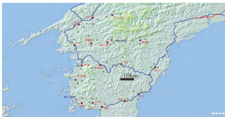
図 11. 2016年3月に設置を予定しているNTTメタリック通信回線網を用いたネットワークMT観測点配置。図中の赤二重丸は交換局の位置を示し、そこにデータ収録装置を設置する。小黄色で示した各地点に電極を埋設し、メタリック通信回線を用いて交換局エリア内の電極間の地電位差変化を記録する。一方で、ピンクのブロックで示した2地点に磁力計を設置し、2015年6月11日より3成分磁場観測を実施している。磁場水平成分に対する長基線地電位差変動の周波数応答関数を推定することにより、地域の広域深部構造を推定する。
