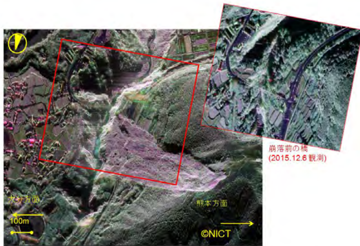
図 1：航空機 SAR ( Pi-SAR2 ) で観測した平成 28 年 4 月 17 日の阿蘇大橋付近の画像 ポラリメトリによる疑似カラー化が施されており、植生部分 ( 緑色 ) と非植生 ( マゼンタ ) の識別により、土砂崩れ部分が抽出される。
