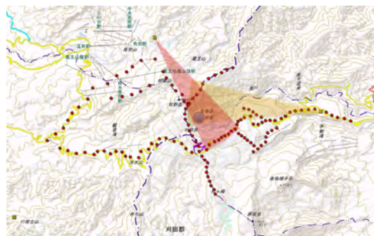
図 4 . 平成 27 年 10 月に実施された人工地震探査実験によりイメージされた減衰域 .
