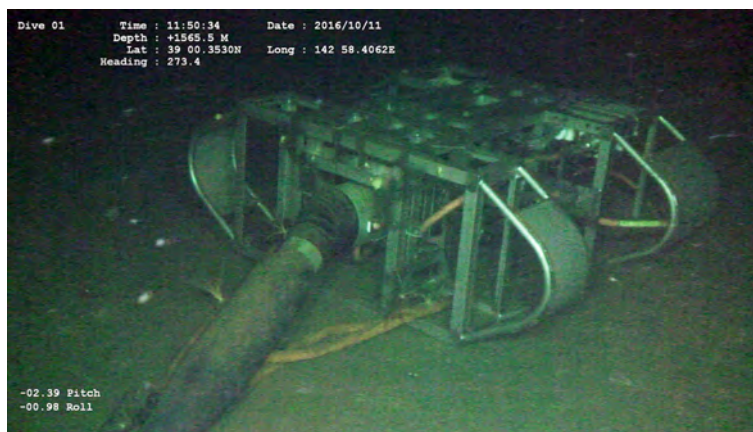
図5 状況確認した新規開発観測システムの観測ノード(YOB3) 観測ノードは中央の円筒容器であり、水中ロボット(ROV)が水中着脱コネクタ部分にアクセスできるように、外側にフレームが取り付けられている。水中着脱コネクタからデジタル出力水圧計に伸びているオレンジ色のケーブルが、確認できる。フレームは、海底における観測ノードの回転抑制にも有用である。
