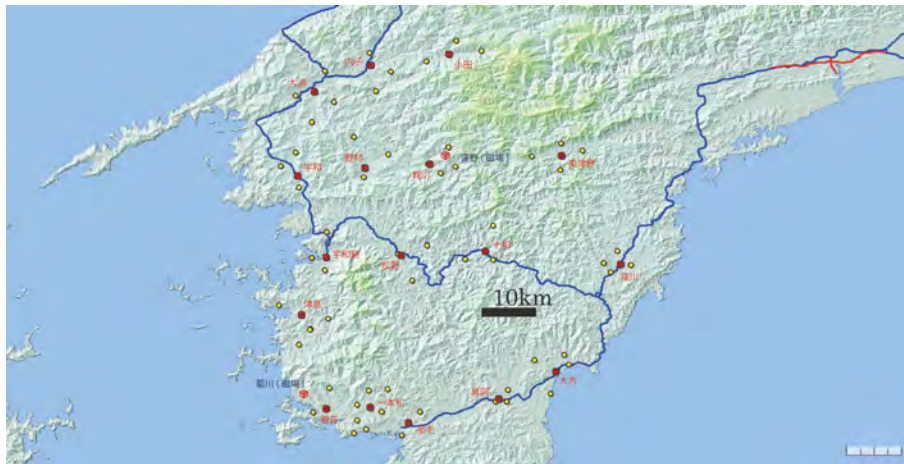
図 13. 2016 年 3 月に設置を完了した NTT メタリック通信回線網を用いたネットワーク MT 観測点配置。データ収録装置設置地点を赤二重丸で示す。その周辺の小黄色で示した各地点に電極を埋設し、メタリック通信回線を用いてエリア内の電極間の地電位差変化を記録している。一方で、ピンクのブロックで示した 2 地点に磁力計を設置し、2015 年 6 月 11 日より 3 成分磁場観測を継続している。電化路線からの漏えい電流ノイズ状況を示すため、図中、青線は非電化鉄道路線、赤線は直流電化路線を示している。
