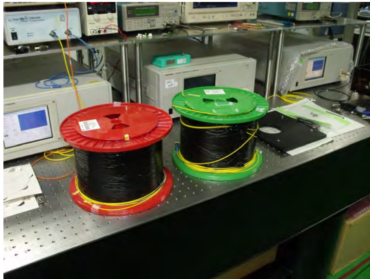
図1 光伝送実験で用いた 26km の光ファイバー（手前）とレーザー光源（奥）
