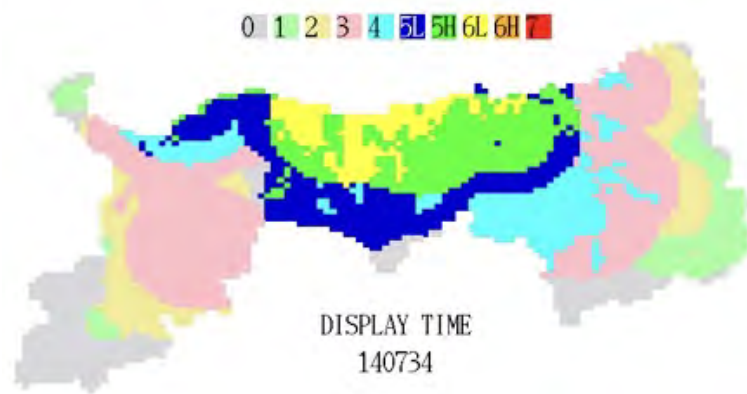
鳥取県震度ネットワークを用いたリアルタイム震度表示例 (2016年鳥取県中部の地震の事後評価)
