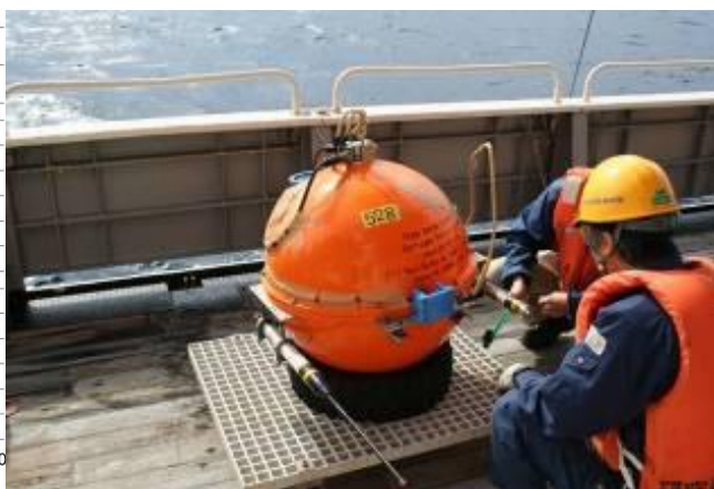
図 48 : 平成 18 年に茨城沖に設置した 5 台の海底強震・高感度地震計(上)、および平成 20 年 5 月 8 日に発生した茨城県沖の地震 (M7.0) の震央近傍での加速度記録(下) (東京大学地震研究所[課題番号:1418])
