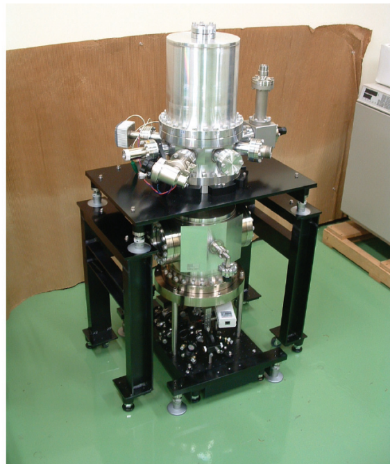
図7. 小型絶対重力計の試作機（東京大学地震研究所[課題番号：1433]）。小型絶対重力計の精度、可搬性等の問題点の洗い出しを行うために、高さ110cm、重さ95kg の試作機を製作した。
