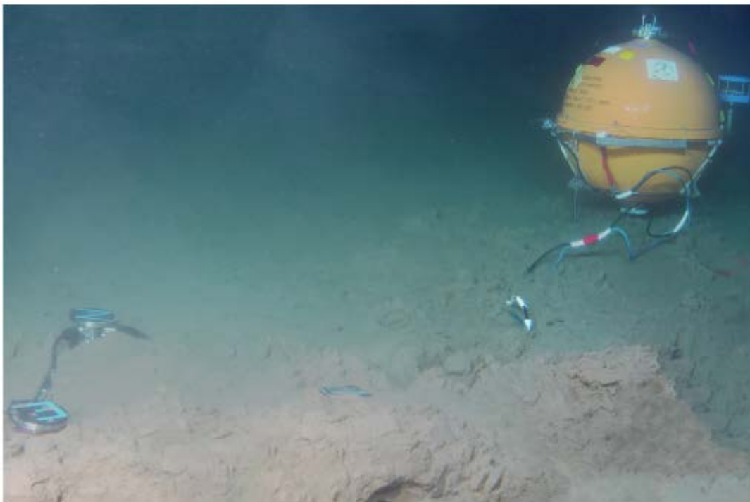
図2. BBOBS-NX の観測時の状態。2010 年6 月に北西太平洋のシャツキー海台西方にて、自由落下方式で投入・ROV で展開したBBOBS-NX の海底（水深5700m）での様子。初の本格的運用であり、2011 年6 月に回収予定(東京大学地震研究所[課題番号:1432])。
