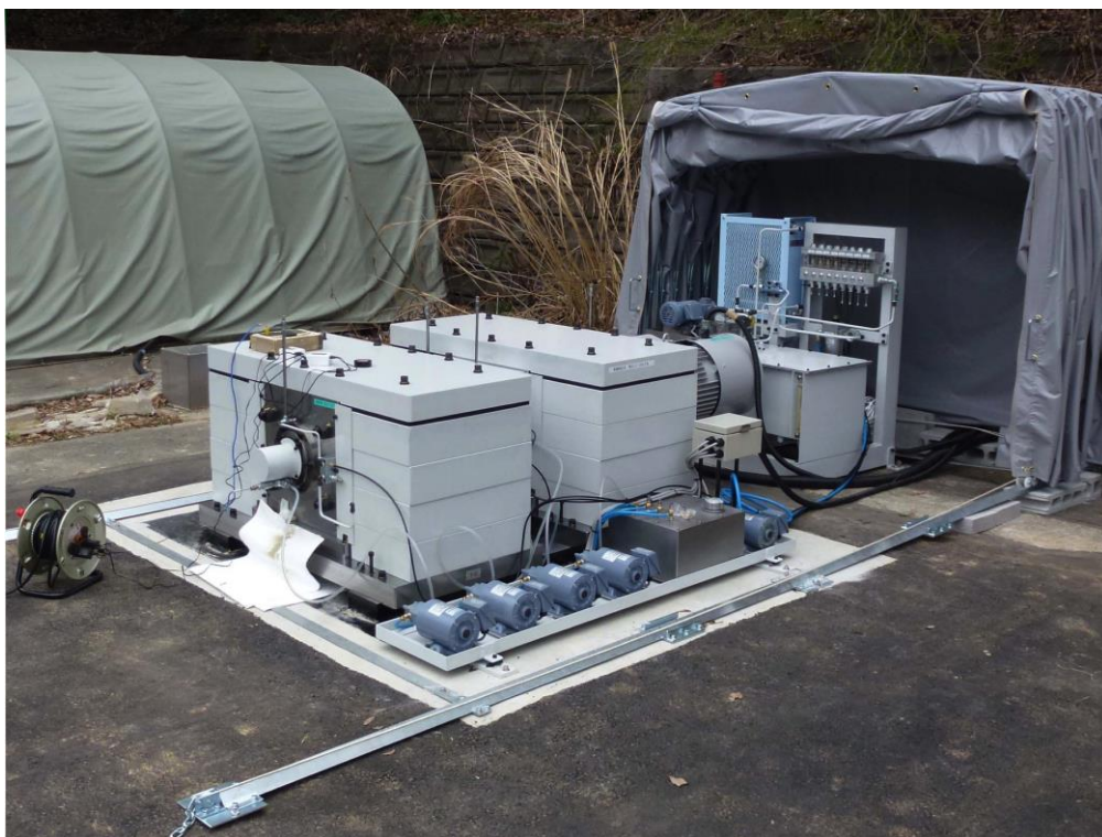
図 5. 名古屋大学三河観測所に設置した第二世代アクロス震源装置（名古屋大学〔課題番号：1705〕）。写真は2台のユニットを直列に連結したところ。
