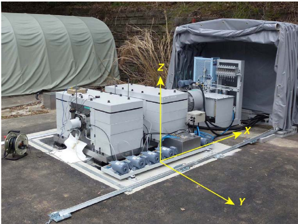
図5. 第2世代アクロス震源装置（名古屋大学〔課題番号：1705〕） 振動測定実験の座標軸を合わせて示した。
