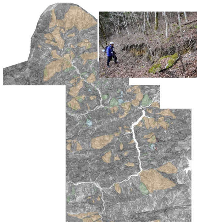
図 10. 0.5mDEM に基づく重力変形、地すべり、過去の崩壊痕跡、急崖など、項目別に分類した危険斜面の分布（国道 194 号線の例）（京都大学防災研究所 [課題番号：DPRI10]） 挿入写真は、長期的な重力変形の影響を受けていると判断された四国の主要国道沿いの斜面における斜面上方の段差亀裂の様子を示す。
