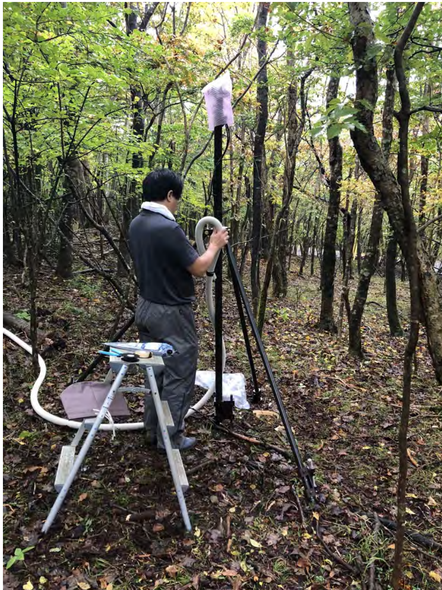
写真1 太郎坊における磁力計設置作業風景
