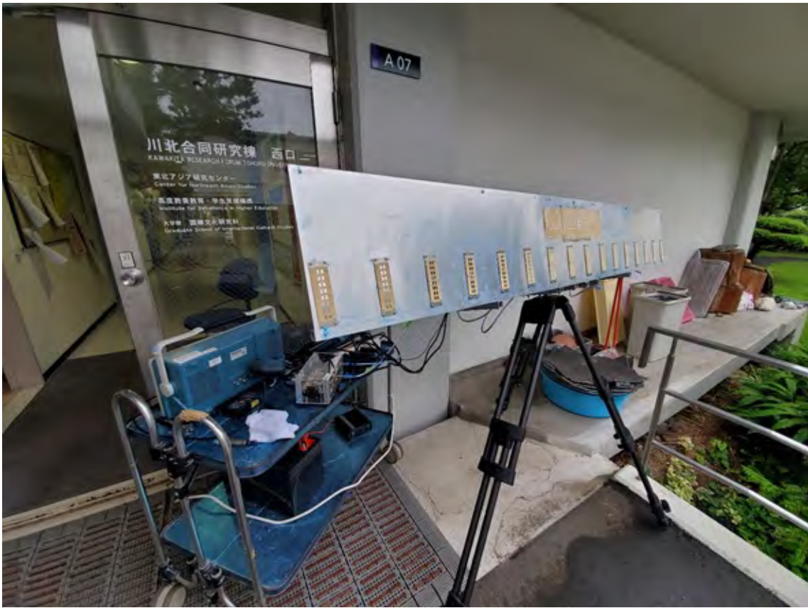
図5 MIMO型GB-SAR装置 東北大学で開発中の17GHz周波数帯MIMO型GB-SAR装置
