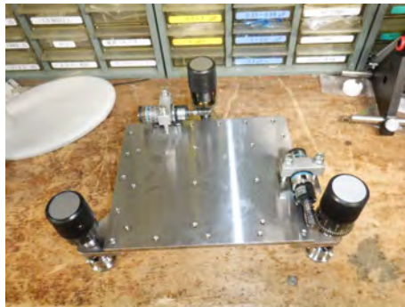
図4 レーザーを射出する基台の部分 熱膨張係数が極めて小さいスーパーインバー合金で製作され、遠隔操作で基台の傾きを微調整できるようにモーターが組み込まれている。
