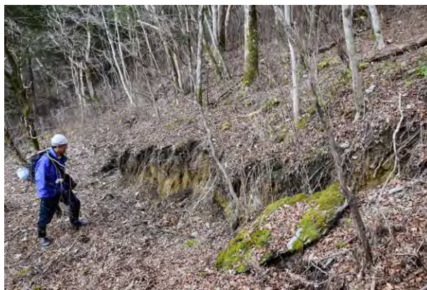
図1: 長期的な重力変形の影響を受けていると判断された四国の主要国道沿いの斜面における斜面上方の段差亀裂のようす。
