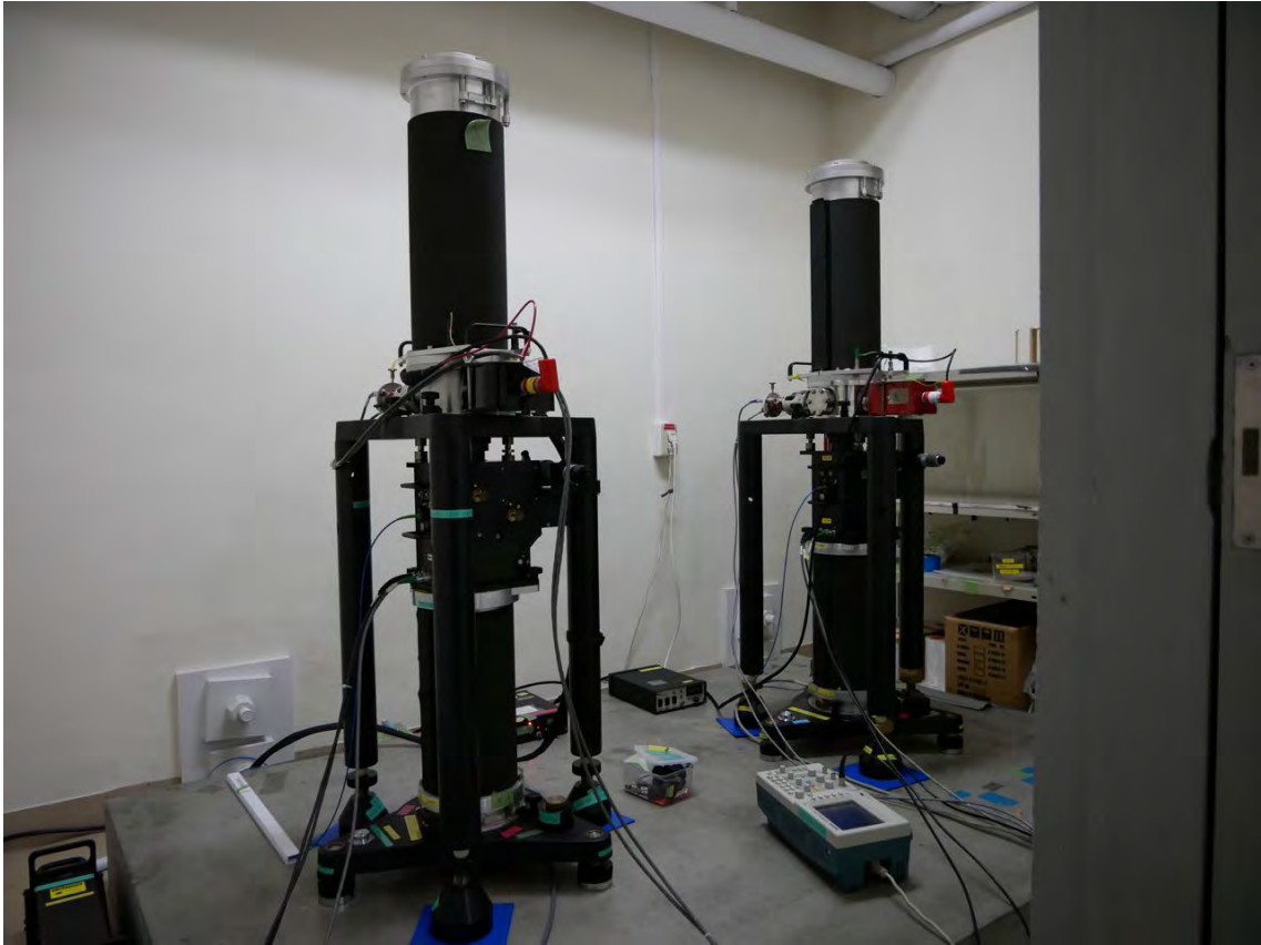
図2 地震研究所における、2台の絶対重力計の器差を検定するための実験の様子。
