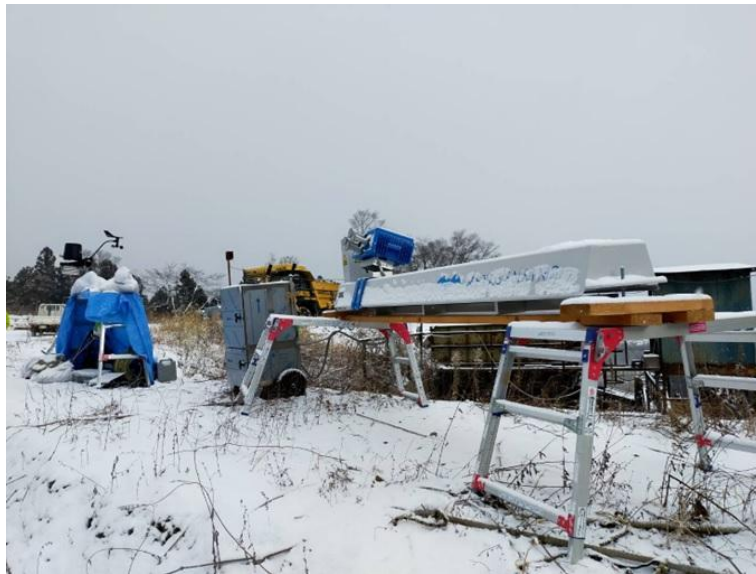
図 5. 17GHz GB-SAR と 79GHz MIMO レーダの同時計測実験の様子 (東北大学災害科学国際研究所 [課題番号: IRID03])。
