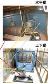
図7. 京都大学桜島火山観測所所蔵の現在稼働中の地震計および微気圧計の一般向け説明図 (京都大学防災研究所[課題番号: DPRI13])
