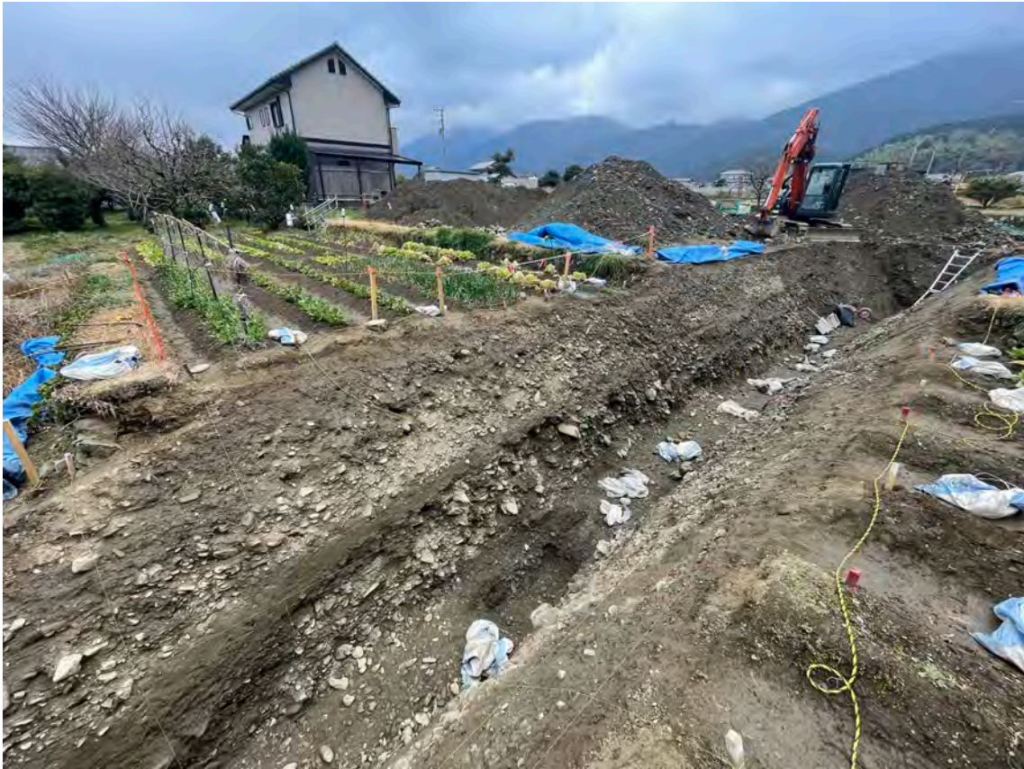
図2 石鎚山脈北縁区間・岡村断層の新居浜市大生院地区における3Dトレンチ調査。 トレンチ東壁面、ほぼ鉛直な断層と北側低下の撓曲変形が露出した。
