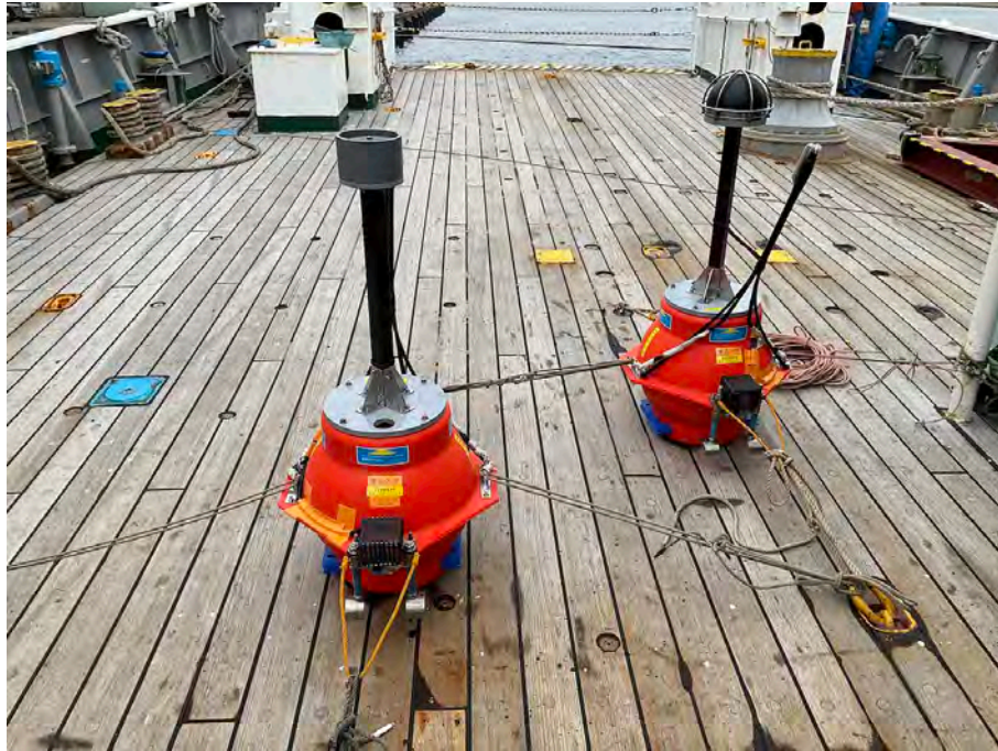
図1 G22に試験的に追加設置した海底局。従来型と比べ音響素子のガラス玉からの距離を離れた他、音響素子のタイプも半球形と円筒形の2種類を用意した。
