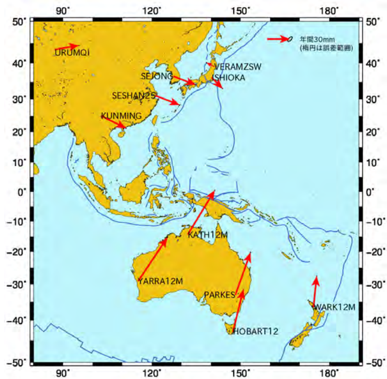
図4 VLBI観測データの解析により得られたアジア・オセアニア地域のVLBI観測局の水平速度
