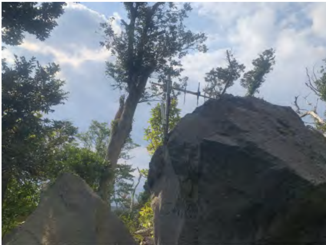
図2. 口永良部島の新設地震観測点の400MHz無線アンテナとGPSアンテナ
