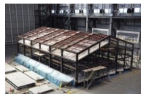
▲Eーディフェンスによる震動実験
