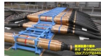
ケーブル式海底観測装置 (地震計・水圧計)
