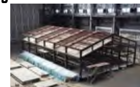
▲E-ディフェンスによる震動実験
