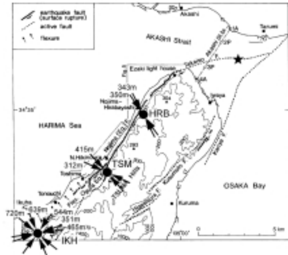
野島断層における応力測定結果。矢印の向きが最大圧縮主応力の向きである。向きが断層と直行していることから、断層面はせん断応力を支えられないと考えられる。
