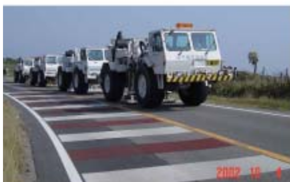
陸上の震源として使用したパイプロサイス (1.2参照)
