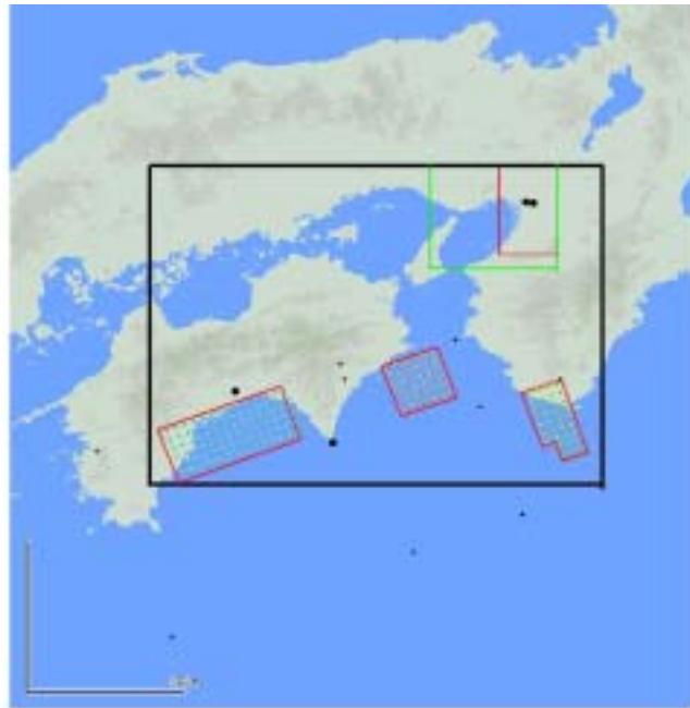
地震調査委員会で設定されている想定南海地震の震源モデル (3.8参照)
