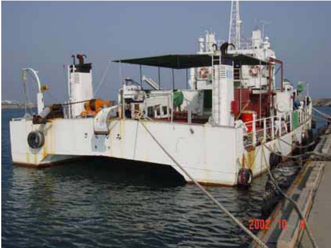
図10 ケーブル敷設船「さちなみ」(111トン)
