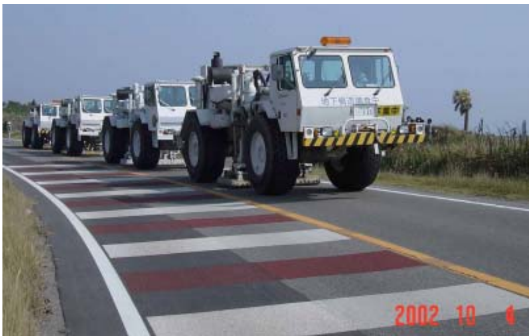
図8. 房総半島白浜でのバイブロサイスの発震状況
