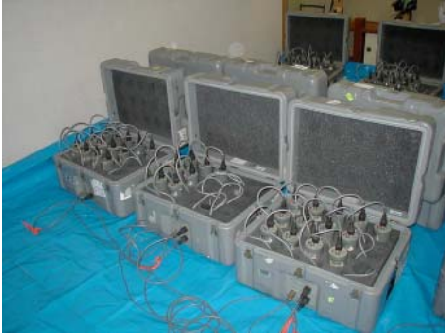
図 34 屈折・広角反射法機材(Texan 型レコーダー, Reftek 125, セットアップのため観測パラメーターを入力中)
