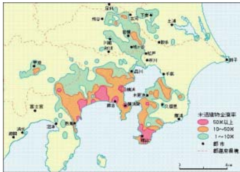
図2 関東地震による木造家屋全壊率および地殻変動
