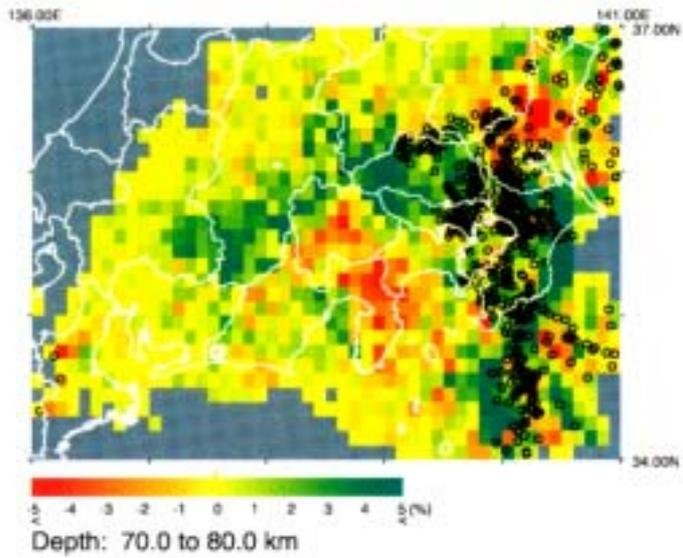
図 1 0 深さ 70-80km での P 波速度分布図。地震が発生していないが高速度な領域が見える。
