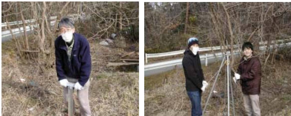
図 1 仙台平野における小型ジオスライサーテスト（津波堆積物採取）。
