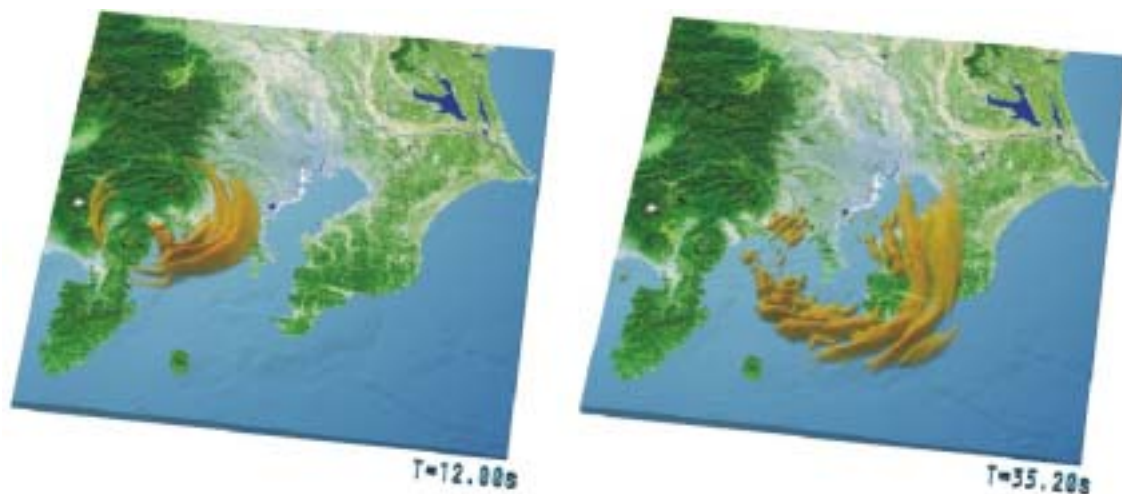
図 3 1923 年関東地震の強震動シミュレーション。地動のスナップショット (地震発生から 12, 35 秒後)。
