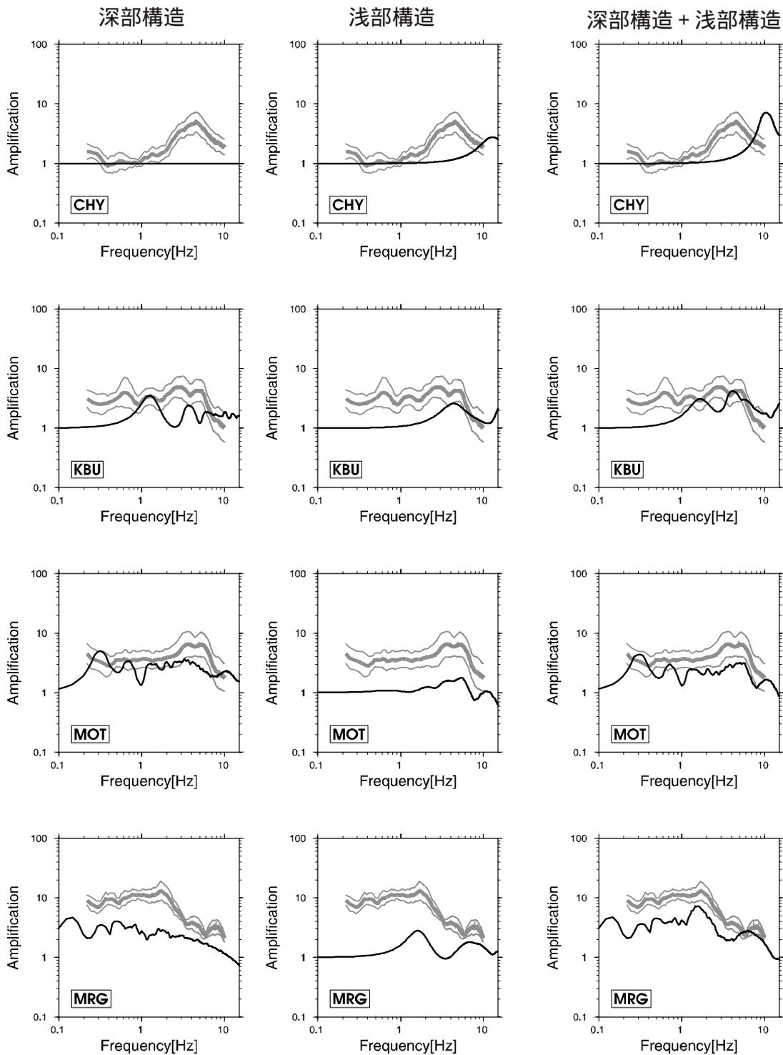
図 9 深部構造と浅部構造の情報がある観測点における理論的サイト増幅特性(実線)と経験的サイト増幅特性(薄太線)。薄細線は経験的サイト増幅特性の標準偏差を示す。深部構造を用いた場合(左)、浅部構造を用いた場合(中央)および深部構造と浅部構造を合成した構造(右)を用いた場合を示す。
