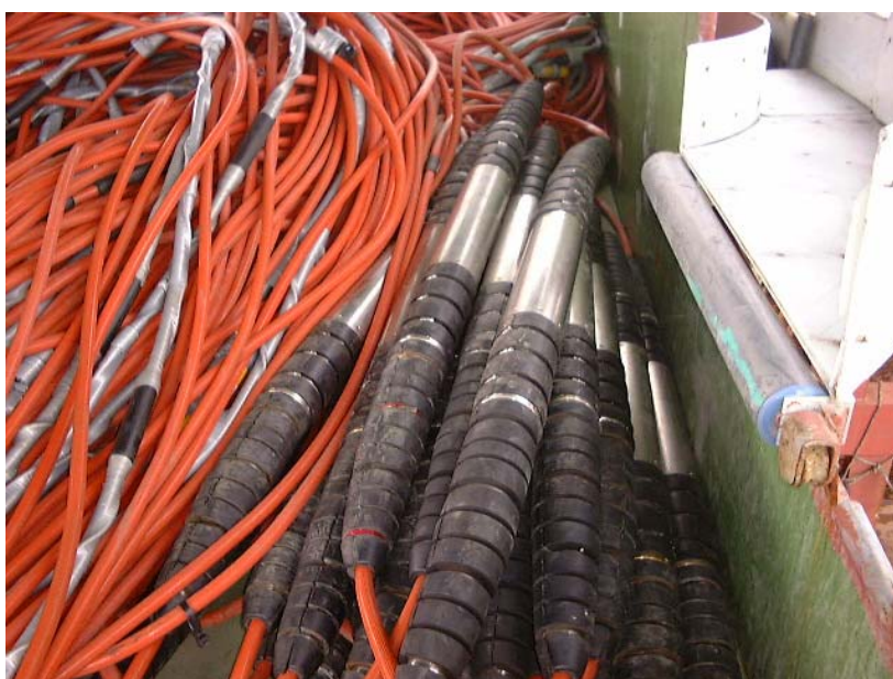
写真7 Ocean Bottom Cable (OBC)、A/D変換・データ伝送部。
