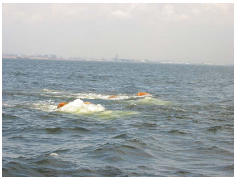
写真9 エアガン発震。 圧縮空気を海中に放出。
