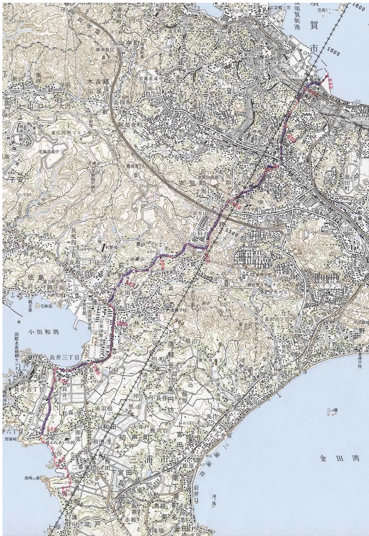
図5 調査測線詳細図・三浦半島陸上受振測線（国土地理院発行 1/50,000 地形図に加筆）
