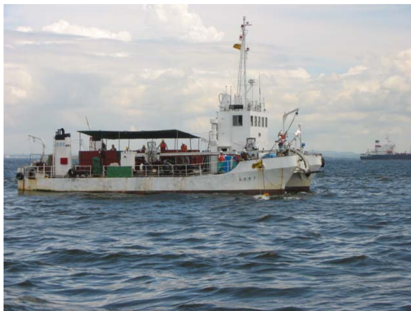
写真5 ケーブル船。 OBCの敷設・回収、Acoustic Positioningを実施。
