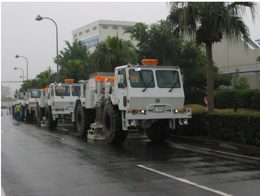
写真1 パイブレータ発震。 三浦半島陸域（横須賀市平成町）。
