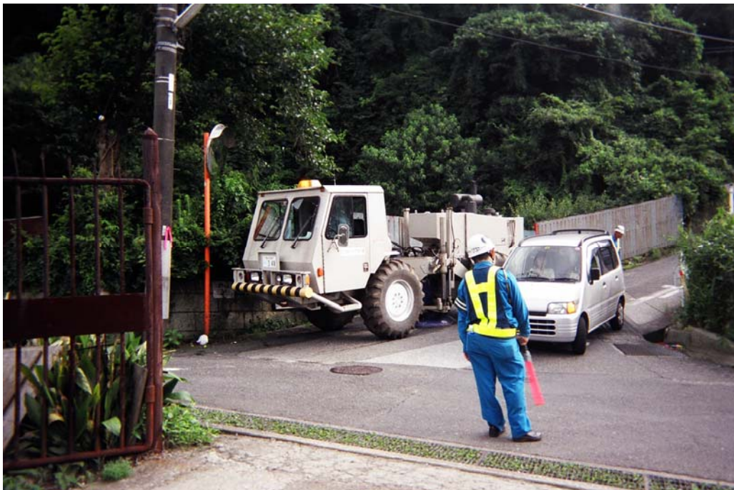
写真2 ミニバイブレータ発震 三浦半島陸域。 住宅密集地や細い道路では、小型バイブロサイス車を震源として使用した。
