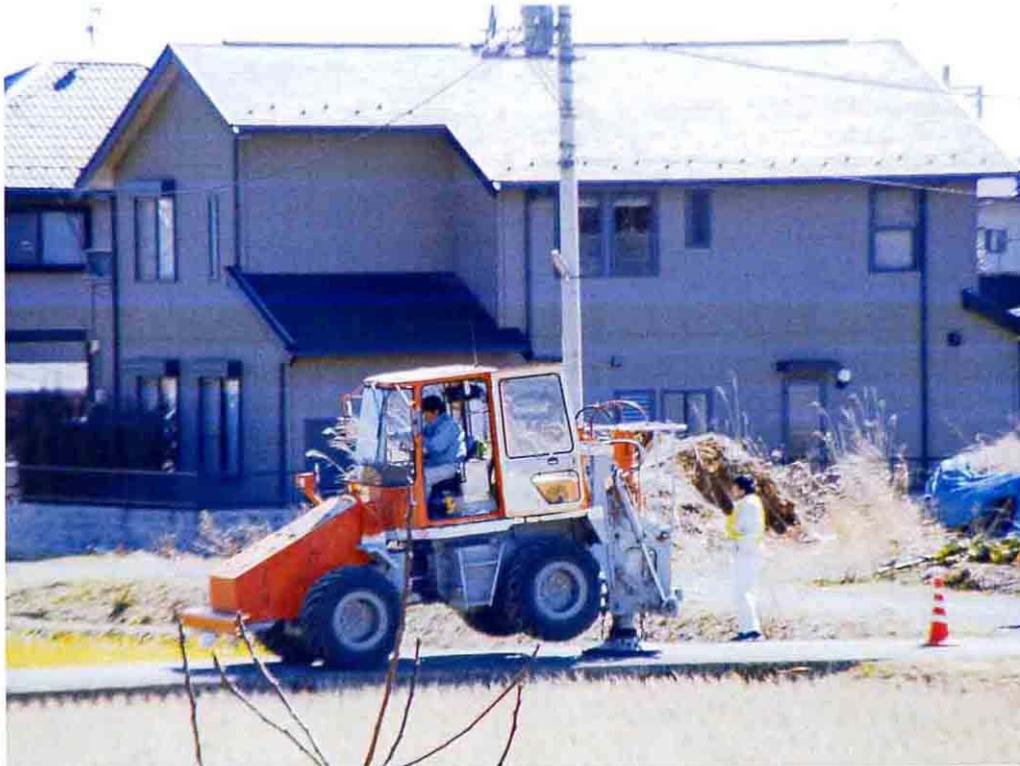
図 4. 発震時の中型油圧インパクトター。
