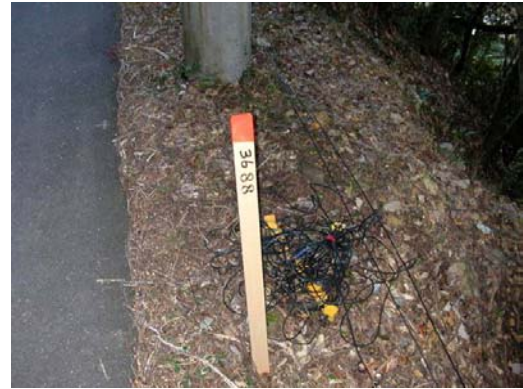
写真5 独立型レコーダ用の受振器(受振点番号 RP.3688)。地面露出部では、写真のように9個組をバンチングで設置。
