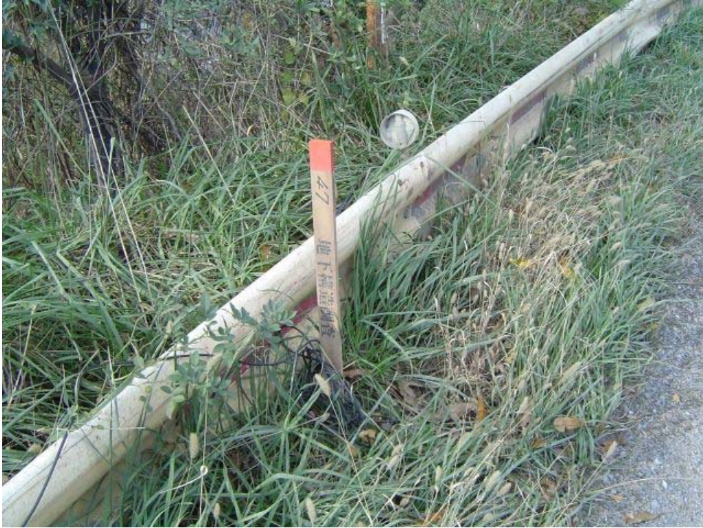
写真1 高槻市内の市道脇に設置された受振器 SM-24、受振番号 RP.47 地点。
