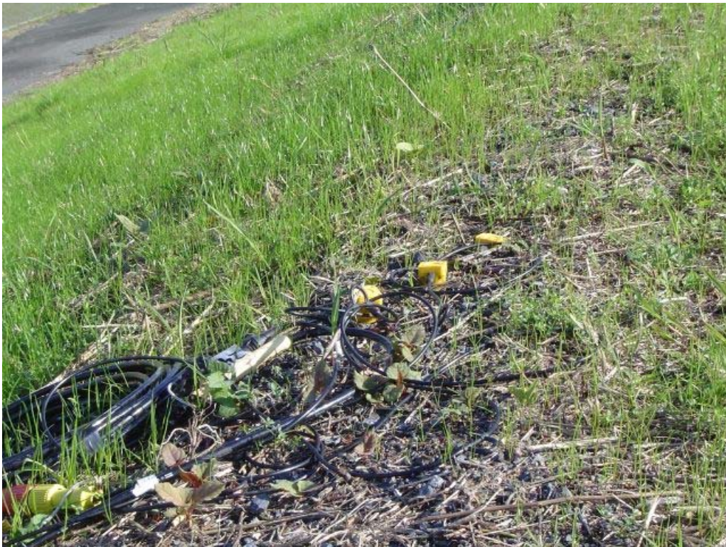
写真2 大阪府枚方市天野川河川敷に設置された受振器 SM-24、受振番号 RP.248 地点。
