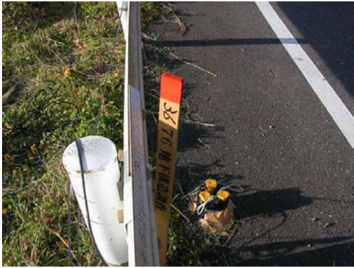
写真4 独立型レコーダ用の受振器(受振点番号 RP.3676)。アスファルト上では、写真のように3個組をバンチングで設置。
