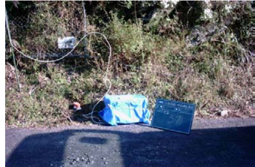
写真7 独立型レコーダ(DAT)と受振器(受振点番号 DAT37, 奈良県十津川村小井)。受振器は、石膏で固めて設置した。
