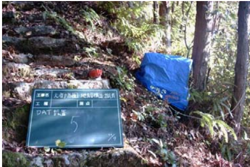
写真6 独立型レコーダ(DAT)と受振器(受振点番号 DAT5, 三重県紀宝町)。ブルーシートの内側が本体。赤い箱が受振器。
