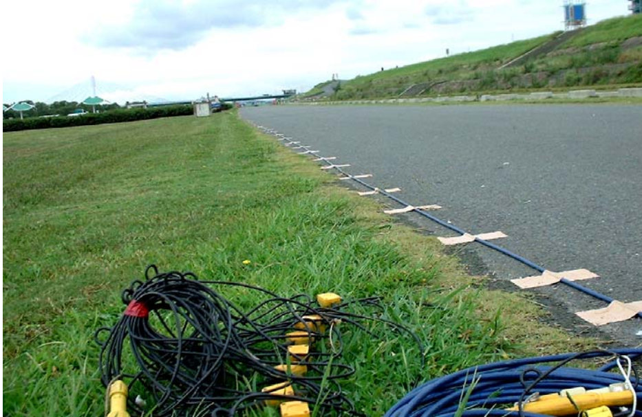
図 7 RP.457 守口市佐太西地区 淀川河川敷。淀川右岸河川敷の約 29.5km の区間においては、保安上の制約から、受振器は原則として 9 個組をバンチング設置した。
