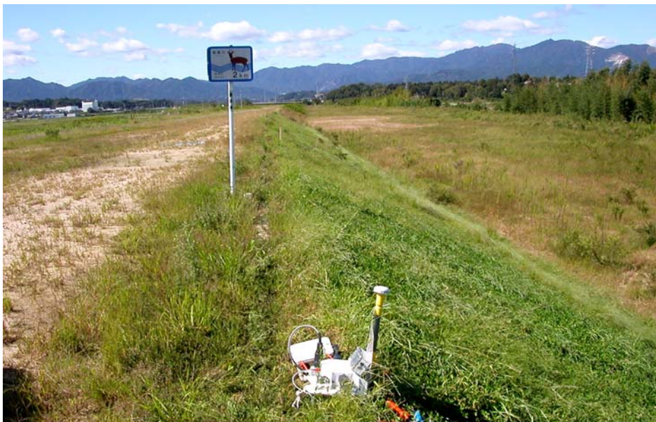
図 8 RP.5238 三重県鈴鹿市小田町地区 安楽川右岸堤防道路。ダイナマイト発振作業において設置された独立型レコーダ MS2000 データ収録装置。
